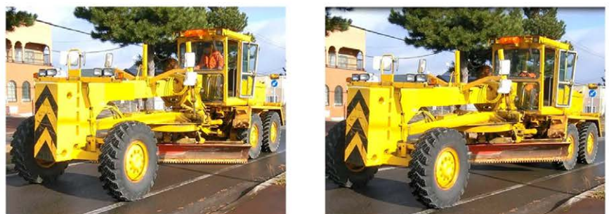
図3 除雪グレーダーのブレード（左：ブレードを下げた状態 右：ブレードを上げた状態）
